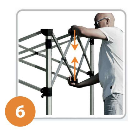
Drücken Sie den Eckverbinder des Scherensystems nach oben bis der Sicherungsbolzen einrastet.
